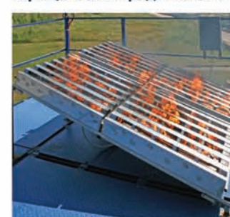
Огневой модуль-имитатор горячей кровли
